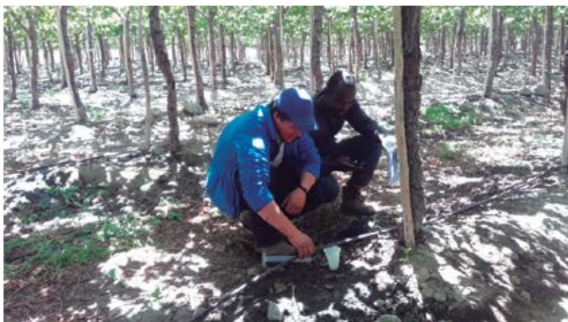
Figura 6. Calibración de un sistema de riego.
