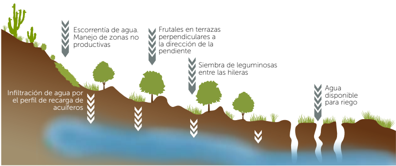
Figura 9. Esquema de diseño de plantación en pendiente.
