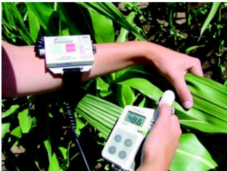
Figura 1. Medidor de clorofila (Minolta SPAD 502) conectado a un almacenador de datos ( logger ) en funcionamiento.
