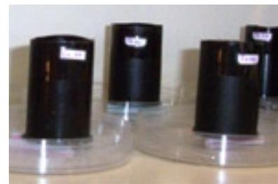
Figura 3. Tubos utilizados en el ensayo de burrito, montados sobre pajillas plásticas.
