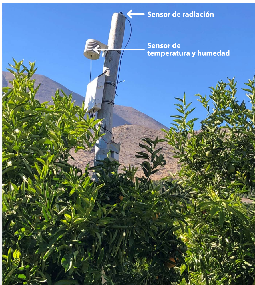
Figura 8. Sistema de monitoreo de variables climáticas: temperatura, presión de vapor y radiación solar.
