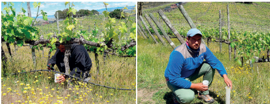
Fotografía 7. Aforo de emisores en viña regada por goteo.
