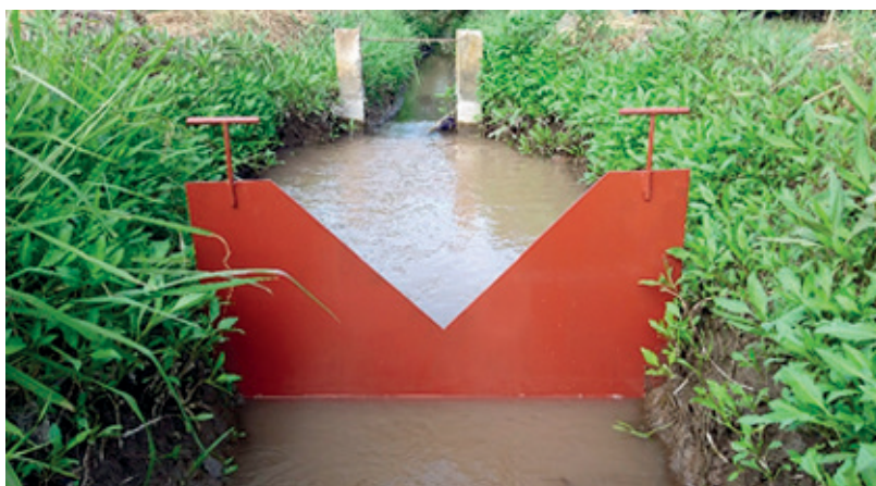
Fotografía 1. Aforo mediante método del vertedero
