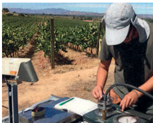
Fotografía 8. Medición de potencial hídrico xilemático de medio día en vid, mediante bomba de Scholander.
