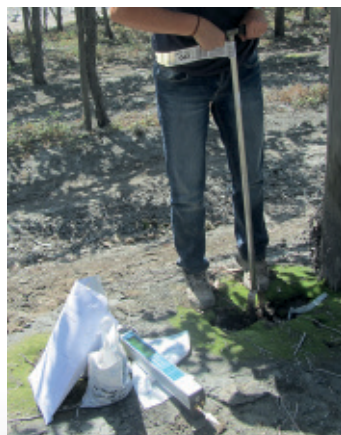
Fotografía 15: Toma de muestra de suelo, en los primeros 20 a 30 cm de profundidad en la zona de crecimiento de las raíces.
